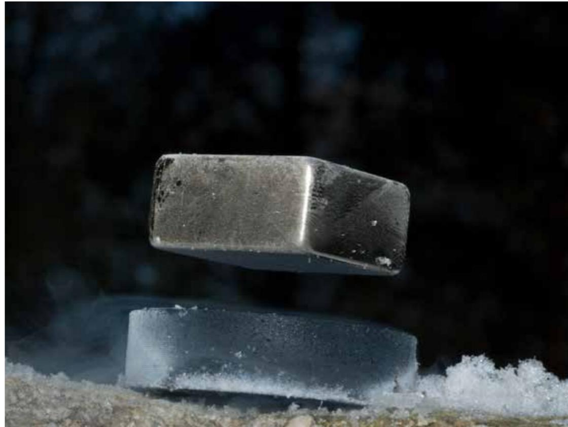
Lévitiation d'un aimant placé au-dessus d'une pastille d'un cuprate supraconducteur.
